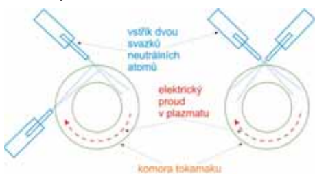
Nastavení injektorů svazků rychlých neutrálních částic na tokamaku COMPASS
