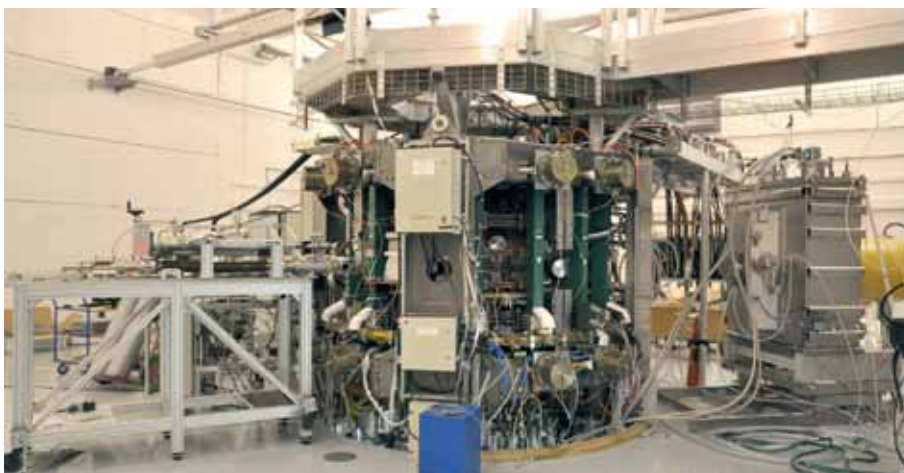
Tokamak COMPASS s připojeným injektorem (vpravo) a diagnostikou Thomsonův rozptyl (vlevo).
