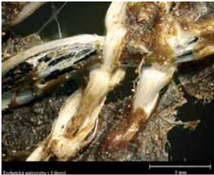
Vzorek_mikro_050x-1 Mikrofotografie zobrazující detailní pohled na suchý nanovláknenný nosič. Stabilita biofilmu je vysoká i po vysušení vzorku.
