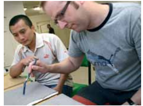
Zbigniew Rozek zkoumá s vietnamským kolegou aplikaci geopolymery na polystyrenové desce
