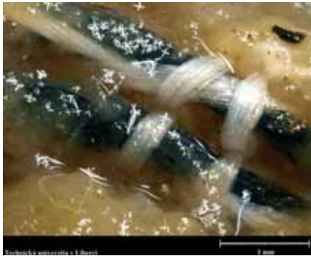
Vzorek_mikro_050x-2 Mikrofotografie zobrazující detailní pohled na vlhký nanovláknenný nosič. Biofilm prorůstá jednotlivé nitě.
